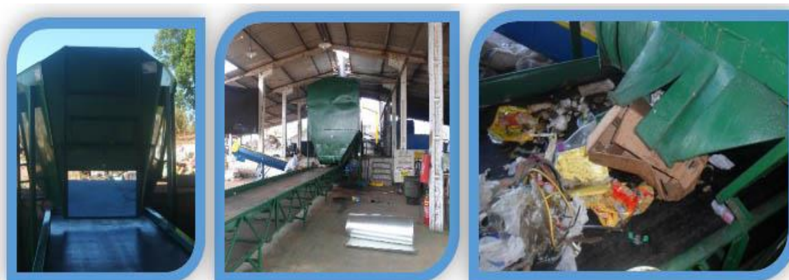
Figuras 5, 6 e 7. Moega de recepção e distribuição do lixo na esteira de triagem.
