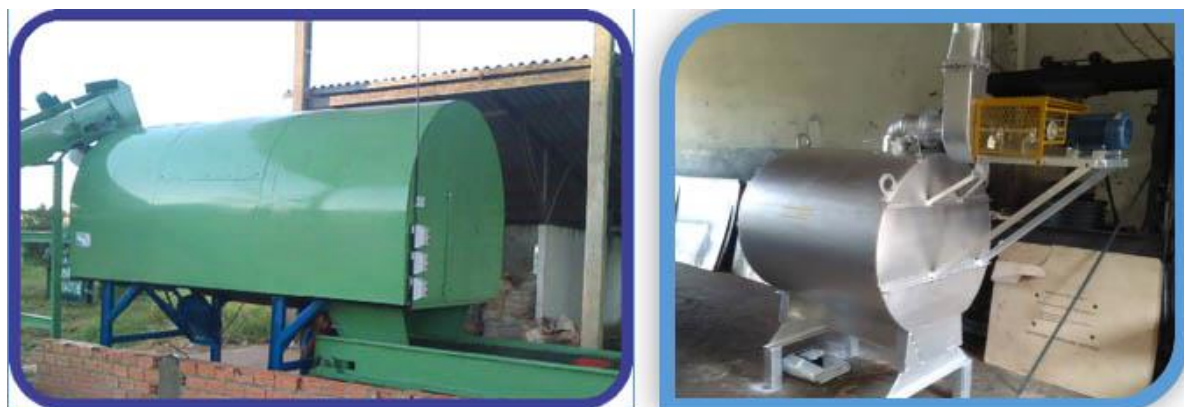
Figuras 3 e 4. Rasgador de sacolas e fornalha.
