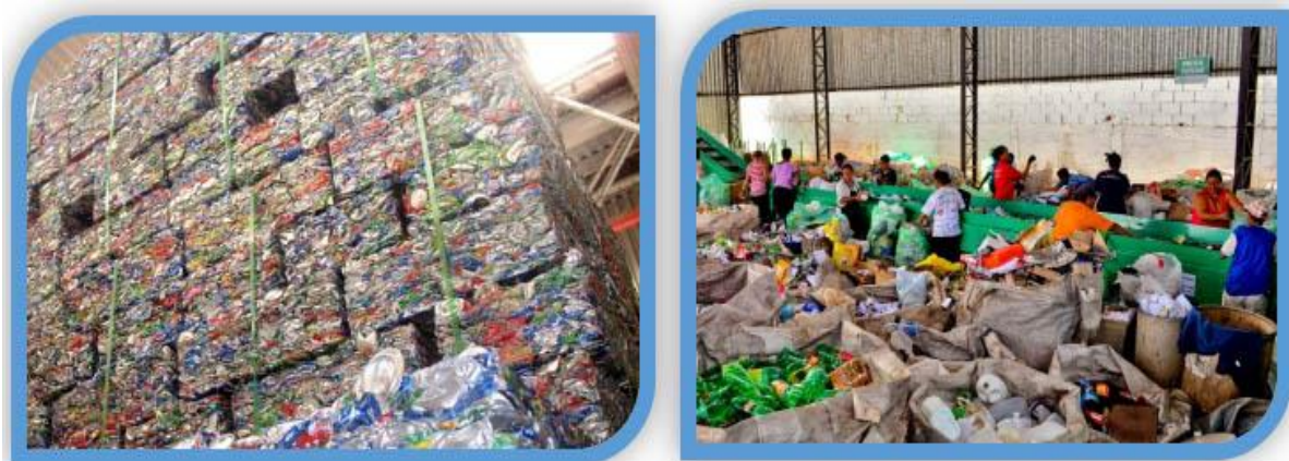
Figuras 13 e 14. Material triado e segregado, pronto para ser trabalhado (latas de alumínio e garrafas Pet).
